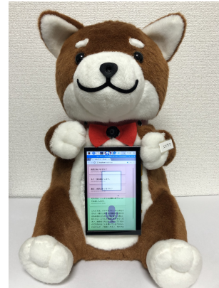
図1 介護用対話システム MICSUS。音声だけでなく表情やジェスチャーも認識可能
